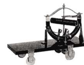
Jedlíkov model elektrického auta
